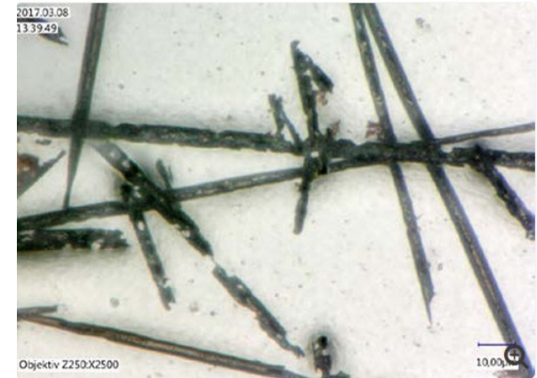
Lichtmikroskopische Aufnahme: Durch thermische Belastung angegriffene CF-Probe. (Foto: KIT)
